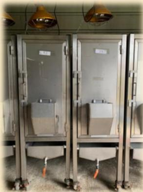
이 사진은 자동 대사 실험틀로, 사료 대사율을 실험하기 위한 장치이다. 사료에 첨가된 단백질의 양과 배변 활동의 결과물의 단백질 양을 측정 및 비교함으로써 해당 사료에 대한 대사율을 측정하는 것이 목적이다. 양돈 영양에 대해서는 3학년 1학기에 배우는 '동물영양학 및 실험'에서 배울 수 있기 때문에 영양학을 들으면 더욱 자세하게 이해할 수 있으리라는 생각이 들었다.
